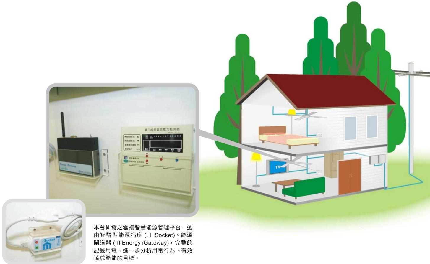
本會研發之雲端智慧能源管理平台，透過智慧型能源插座 (III iSocket)、能源閘道器 (III Energy iGateway)，完整的記錄用電，進一步分析用電行為，有效達成節能的目標。
